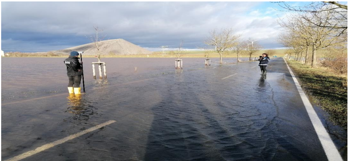
Abbildung 56 Einmessung Wasserspiegel Verbindungsstraße Katharinenrieth- L219
