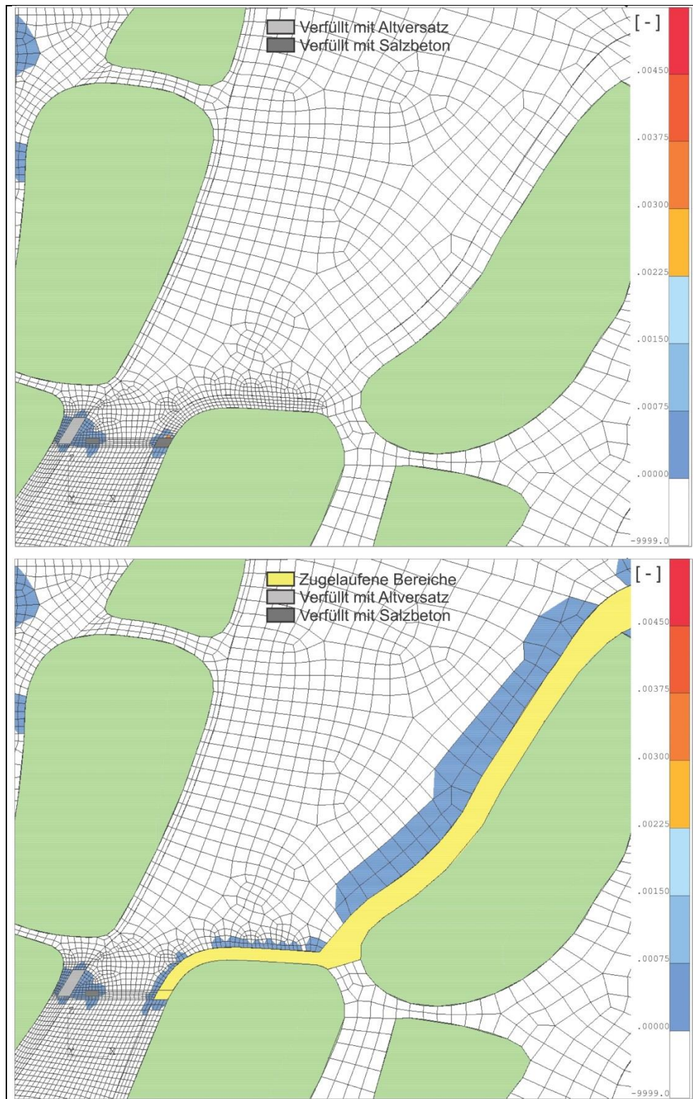
Abbildung 5-4: Dilatante Gebirgsbereiche im Bereich der Engstelle zwischen Lager B und Lager C zu den Berechnungszeitpunkten t = 85 Jahre (oben) und t = 20.000 Jahre (unten) (aus [I 399] Anlagen 6.2 und 6.3)
