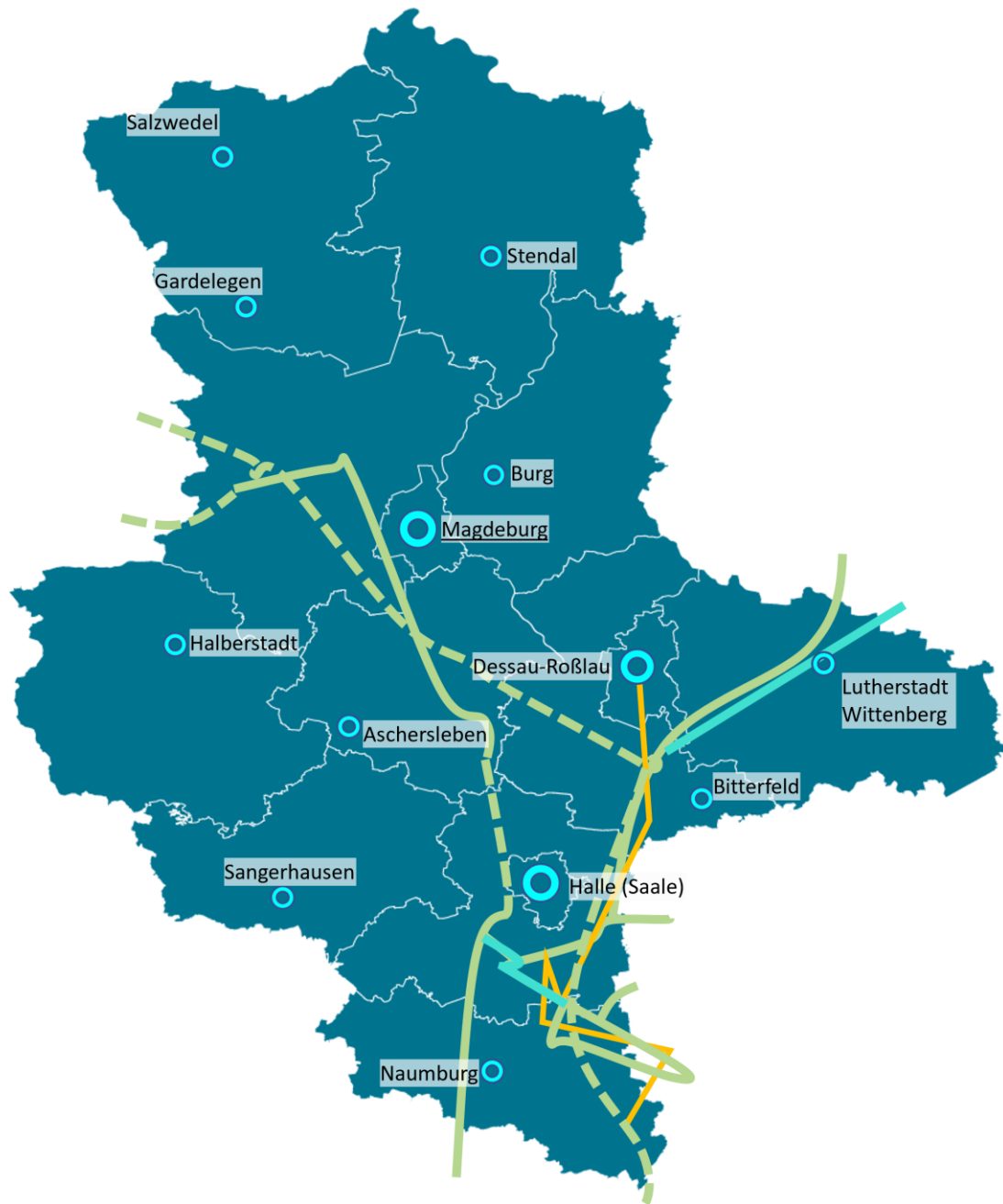
Abbildung 18: Wasserstoffleitungen in Sachsen-Anhalt (orange: bestehende Linde-Leitung im Mitteldeutschen Chemiesiedreieck, türkis: Wasserstoff-Kernnetz in 2025, hellgrün: geplantes Wasserstoffkernnetz, gestrichelte Linien: Neubau, sonst Leitungsumstellung)
